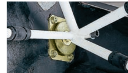
Konuslager als elastische Verbindung von Fahrwerk und Kabine
