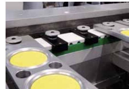
Abb. 4: Befestigung der Kapselträger am Zahnriemen
