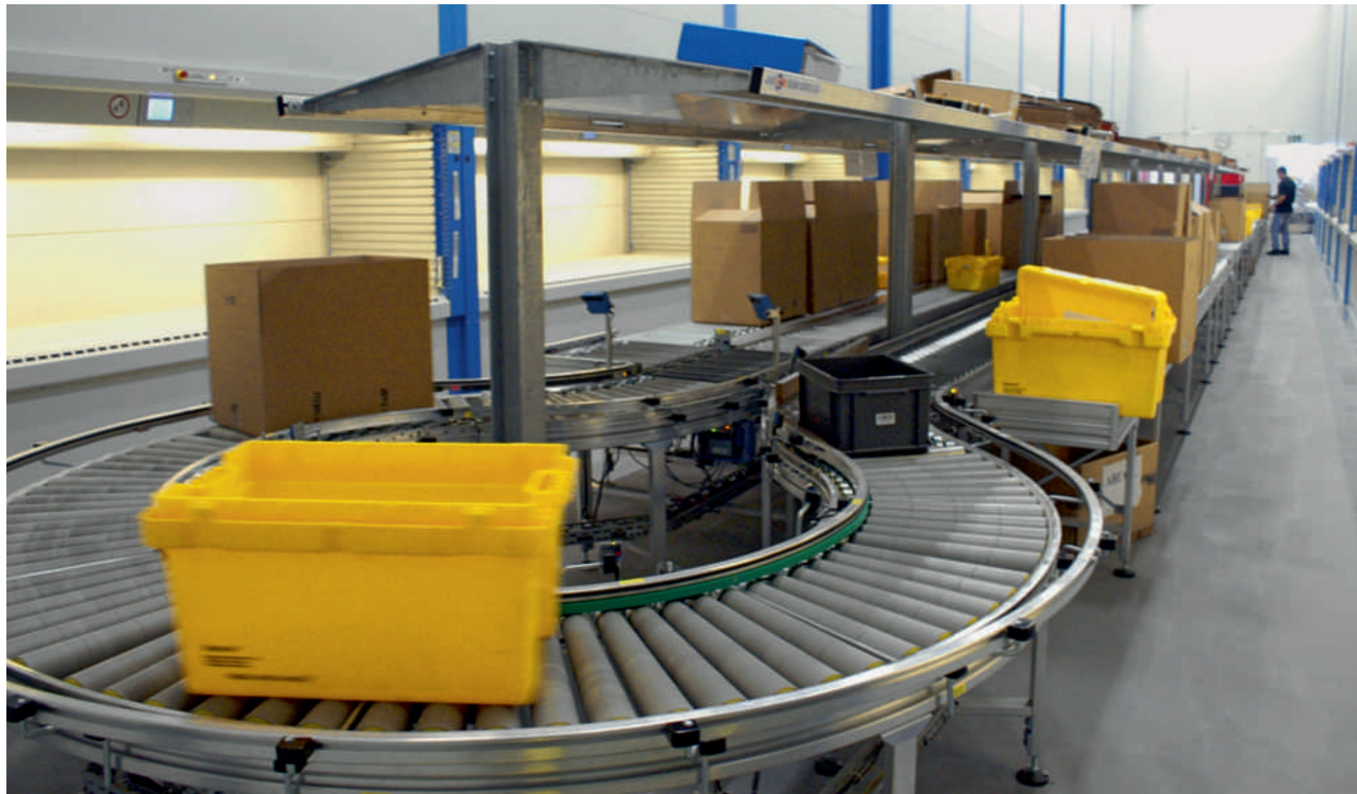
Handelsunternehmen nutzen die Behälterfördersysteme von Gilgen Logistics, ebenso etwa Spitäler und Bibliotheken. Für den Antrieb des Staurollenförderer-Moduls und des Hubumsetzer-Moduls verwendet Gilgen Logistics den Gleichstrom-Getriebemotor von Angst+Pfister.
