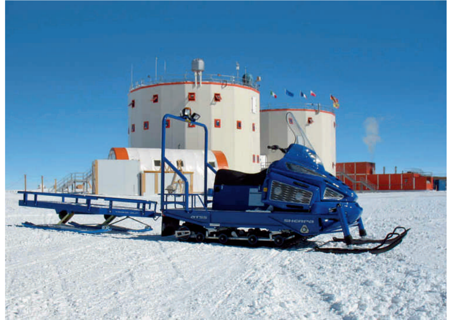
Elle se trouve en service jusque dans les stations de recherche de l'Antarctique. Même la remorque a un amortisseur de vibrations.
