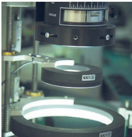
Die visuelle Prüfung eines O-Rings unter dem Mikroskop bei MCM in Italien.
