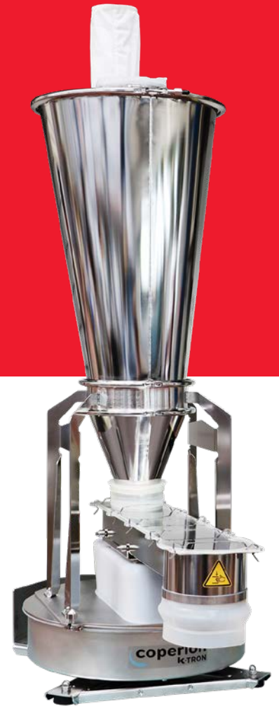
Die weisse Silikonabdeckung auf der Dosierwaage schützt deren Elektronik – ohne die Vibrationen zur Förderung des Schüttguts zu stören.
