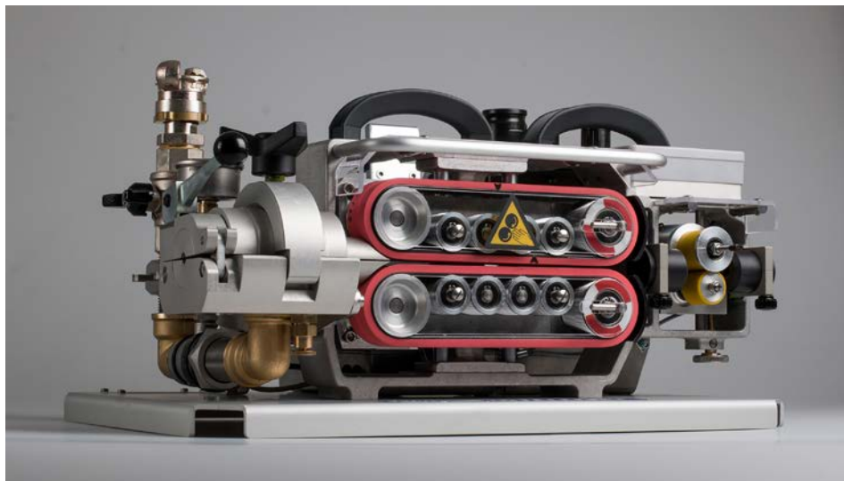
Le cinghie di trasmissione rosse spingono i cavi nei tubi. Il nuovo rivestimento consente una presa ottimale dei cavi.
