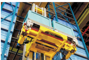
Système logistique de rayonnages à grande hauteur
