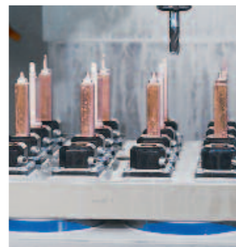
Palette avec mécanisme de bridage
