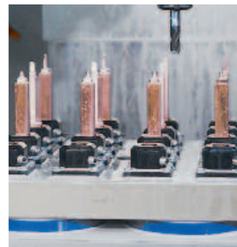
Pallet di ricambio con meccanismo di fissaggio
