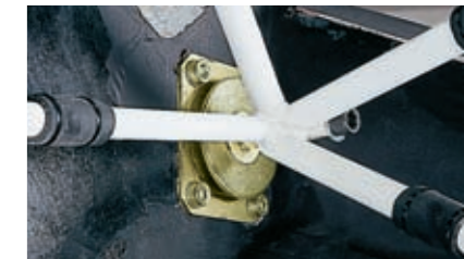
Giunzione elastica tra telaio e cabina con coni antivibranti
